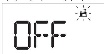
Obr.5 Vypnutí činnosti kotle v režimu přípravy teplé vody (TV)
